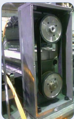
采用传统伺服电机、齿轮头、皮带和皮带轮制造的冲床给料机器。
