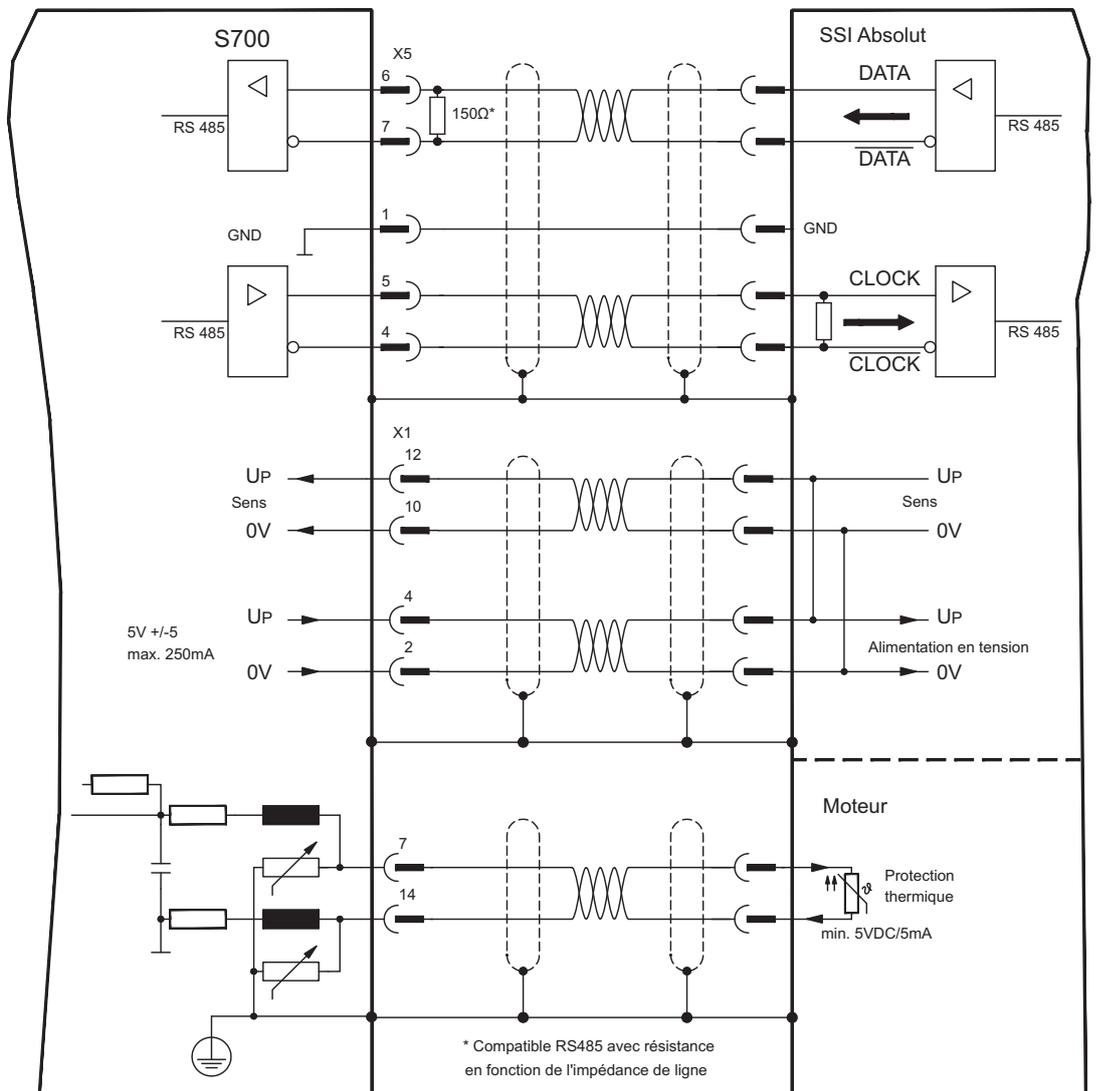
10.2.3.1.4 Codeur Sine avec SSI (X5, X1)
