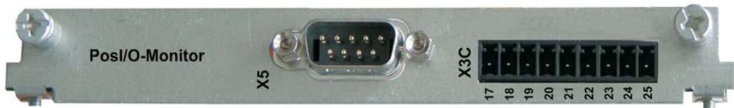
La carte d'expansion met à disposition outre X5, le connecteur mâle X3C avec entrées et sorties analogiques +/-10 V (reportez-vous à la page 150, chapitre "E/S analogiques"), dont les fonctions peuvent être configurées à l'aide du logiciel de mise en service ou de macrofonctions.
