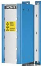
Les modules **KCM (KOLLMORGEN Capacitor Module)** absorbent l'énergie cinétique produite par le moteur en mode générateur. Normalement, cette énergie est transformée en puissance dissipée via les résistances de freinage. Les modules KCM réinjectent l'énergie stockée dans le circuit intermédiaire dès que c'est nécessaire. Dimensions (H x l x P): 300x100x201 mm
