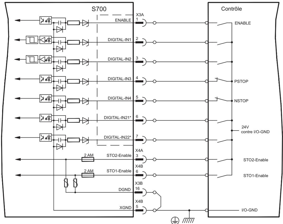
\* Les entrées DIGITAL-IN21 et 22 doivent être définies comme entrées à l'aide du logiciel de mise en service (Page "I/O digital")
