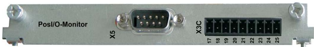
La carte d'expansion met à disposition outre X5, le connecteur mâle X3C avec entrées et sorties analogiques +/-10 V (reportez-vous à la page 142, chapitre "E/S analogiques"), dont les fonctions peuvent être configurées à l'aide du logiciel de mise en service ou de macrofonctions.
