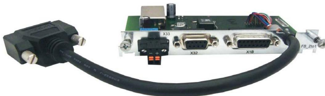
Ce chapitre décrit la carte d'expansion de rétroaction FB-2to1 pour le variateur S748/772. Cette carte permet de raccorder simultanément un système de feedback primaire numérique et un système de feedback secondaire analogique au connecteur X1. L'alimentation d'une tension auxiliaire de 24 V DC sur X33 est convertie sur la carte d'expansion en une alimentation de codeur précise de 5 V CC pour le feedback secondaire.
