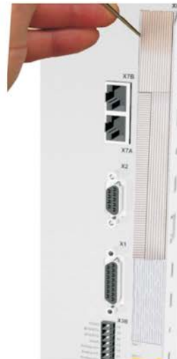
2 - Folie lösen (Perforierung)
