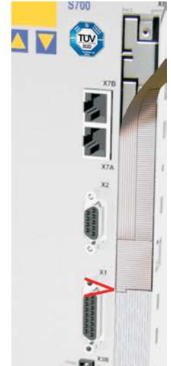
3 - Folie abreißen (bis zur Markierung)
