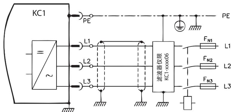
图 9. AC 输入电源接线图
