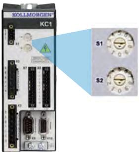
图 10. 静态 IP 寻址旋转开关
