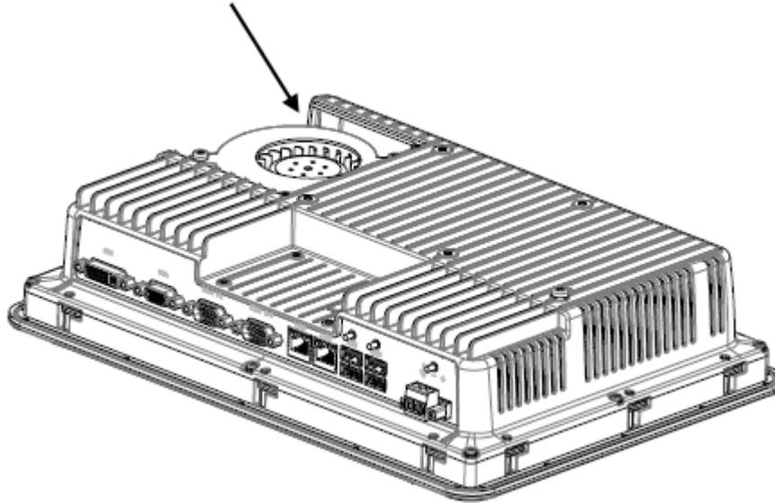
Siga las instrucciones del capítulo [Sustitución del ventilador y del filtro](#) sobre cómo desmontar la cubierta del ventilador para poder acceder al interruptor de reinicio.
