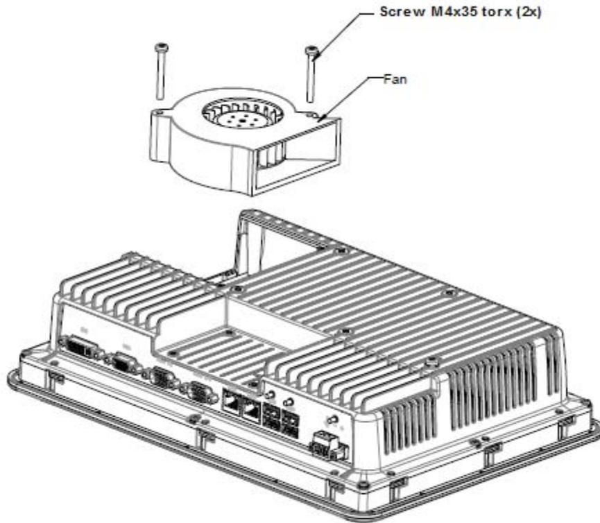
5. Coloque el ventilador nuevo y, a continuación, el filtro de repuesto. Para fijar los tornillos del ventilador, utilice un par máximo de 0,4 Nm.
