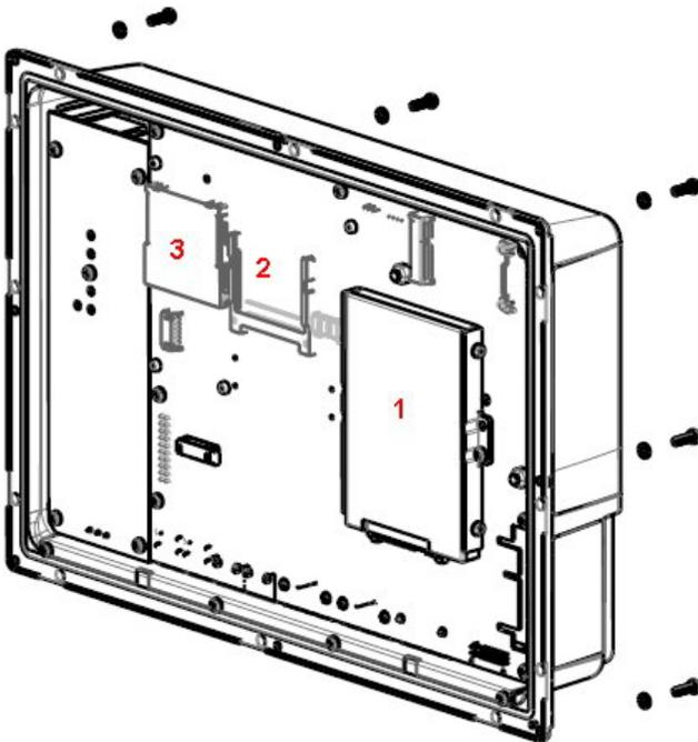
**Figura 4-1:** 1. Un dispositivo de almacenamiento masivo SATA de 2,5"
