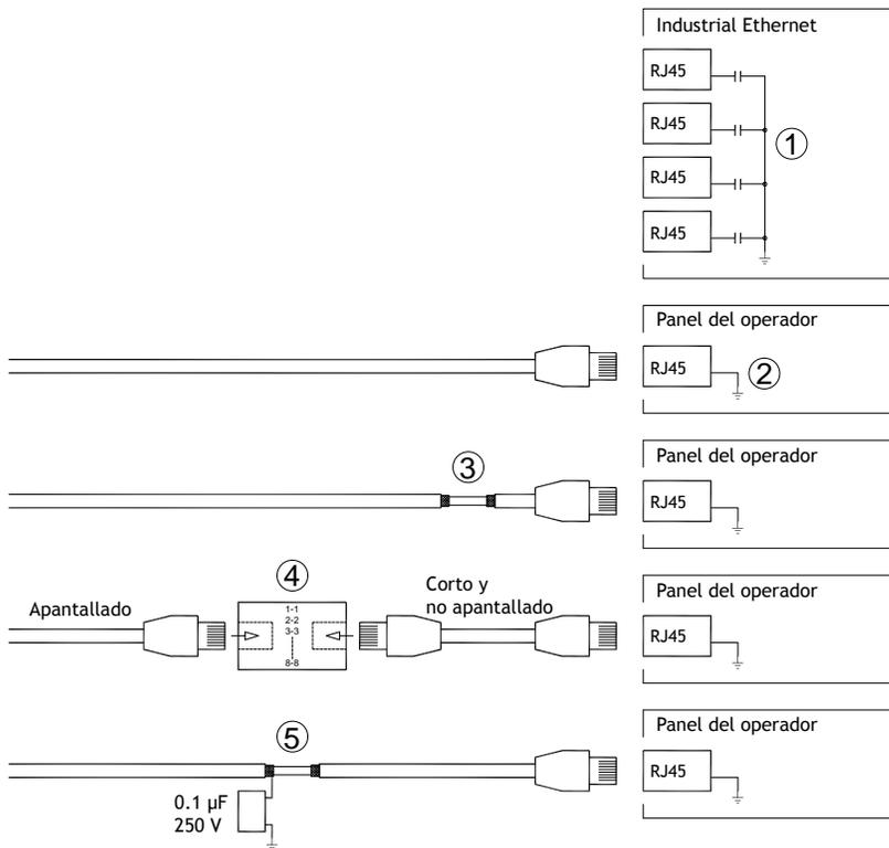
En algunas unidades industriales para Ethernet, el apantallado del conector RJ45 va conectado al chasis a través de un condensador, vea 1 en el dibujo arriba.
