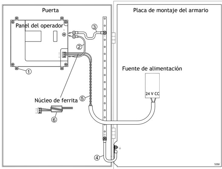
Las abrazaderas de montaje del panel de operador no permiten una conexión de puesta a tierra segura entre el panel y el armario del dispositivo, vea 1 en el dibujo arriba.
