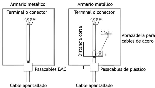
1. Utilice un pasacables EMC o un pasacables de plástico normal, retire la cubierta exterior y conecte el apantallado a la placa de instalación con una abrazadera metálica para cables de 360°.
