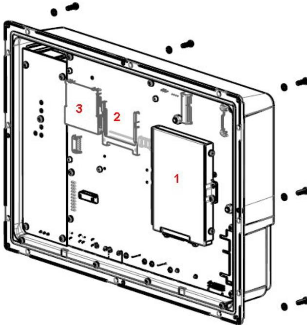
**Figura 4-4:** 1. Un dispositivo de almacenamiento masivo SATA de 2,5"
