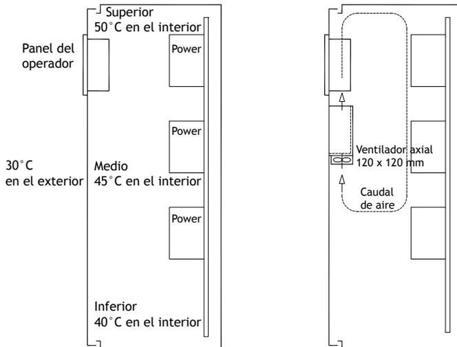
En la mayoría de los casos, la temperatura ambiente del panel de operador es ligeramente superior que la temperatura ambiente del armario del dispositivo.
