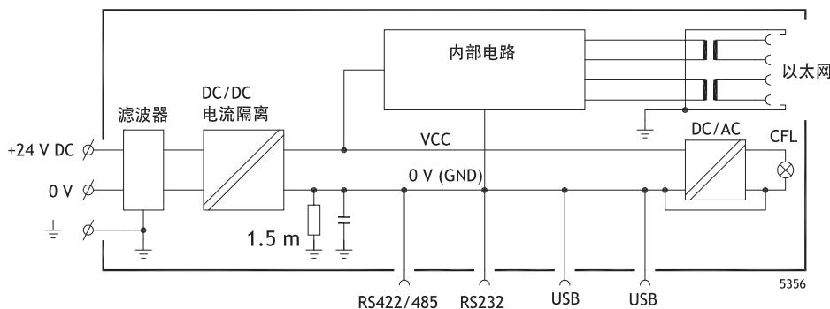
操作面板与 24V DC 电源之间存在电流隔离，但 RS232、RS422/485 和 USB 通信端口之间却不存在电流隔离。仅以太网连接存在电流隔离。
