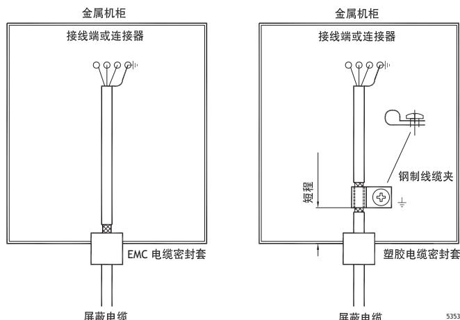
1. 使用 EMC 电缆密封套或普通塑料电缆密封套，去掉外罩，然后使用  $360^\circ$  金属电缆夹将屏蔽连接到安装板。
