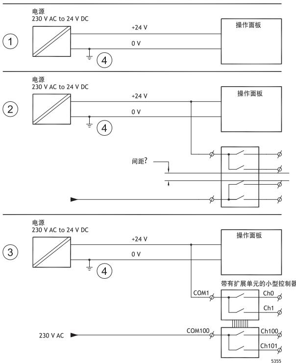
如果使用的电源满足安全标准且仅为操作员面板供电，则不会出现任何问题。请参阅上图中的 1。但是，如果使用为其它单元供电的 24V 电源，我们提醒您务必小心，请参阅上图中的 2。操作员面板不具备符合安全要求且能够承受 230V AC 到 24V DC 的短路的绝缘性能。假设 24V 馈电安全，例如，SELV 符合 EN 60950（防电击保护）和 UL 950。
