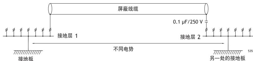
如果距离较长，则可能存在接地电位不同的风险。在这种情况下，只能在一端连接屏蔽。另一种良好的备选方法是通过  $0.1\text{F}/250\text{V}$  塑料电容将屏蔽的另一端连接到地面。然后，如果是高频，将两端连接到地面；如果是低频，则仅将一端连接到地面，这样便可以避免  $50/60\text{Hz}$  的接地回路。
