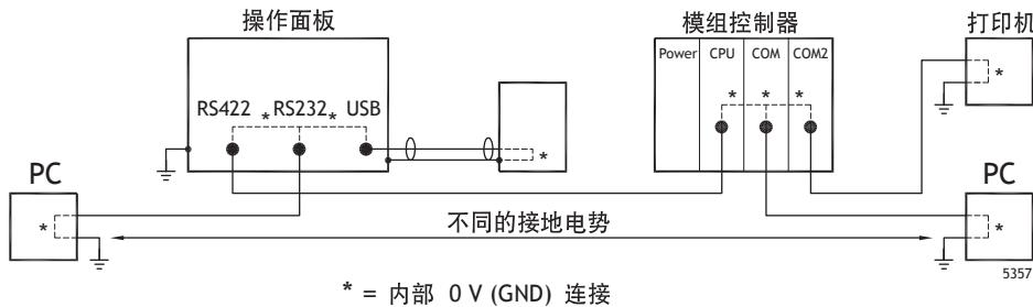
PC 与操作面板连接时，操作面板的内部 0V（接地）将通过 PC 保护性接地。
