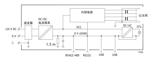
操作面板与24VDC电源之间存在电流隔离,但RS232、RS422/485和USB通信端口之间却不存在电流隔离。仅以太网连接存在电流隔离。
