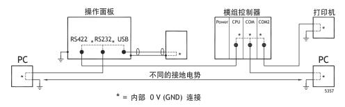
PC与操作面板连接时,操作面板的内部 OV (接地)将通过 PC 保护性接地。
