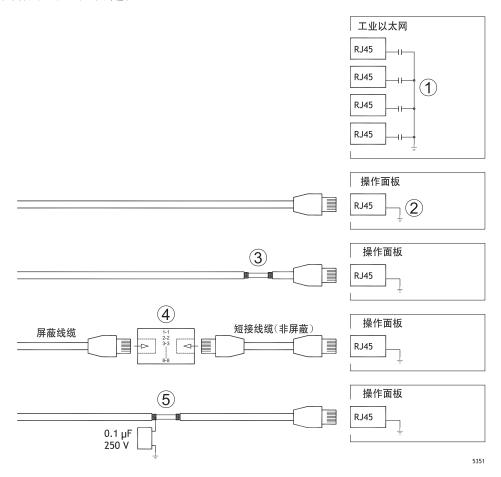
在一些工业以太网装置中,RJ45接口的屏蔽需通过电容连接到底架,请参见上图中的标号1。 而操作面板的以太网屏蔽则直接连接到底座,请参见上图中的标号2。
