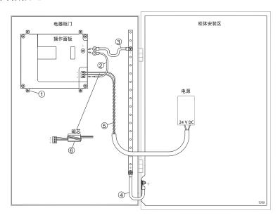
操作面板的安装夹无法使操作面板与设备机柜之间的接地连接牢固,请参见上图中的标号1。
