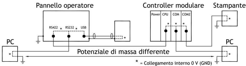
Quando al pannello dell'operatore viene collegato un PC, la connessione interna di terra a 0 V (GND) del pannello viene collegata alla messa a terra di protezione tramite il PC.
