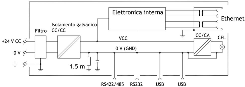
Il pannello operatore è provvisto di isolamento galvanico rispetto all'alimentazione a 24 V CC, ma non esiste isolamento galvanico tra le porte di comunicazione RS232, RS422/485 e USB. Solo il collegamento Ethernet è isolato galvanicamente.
