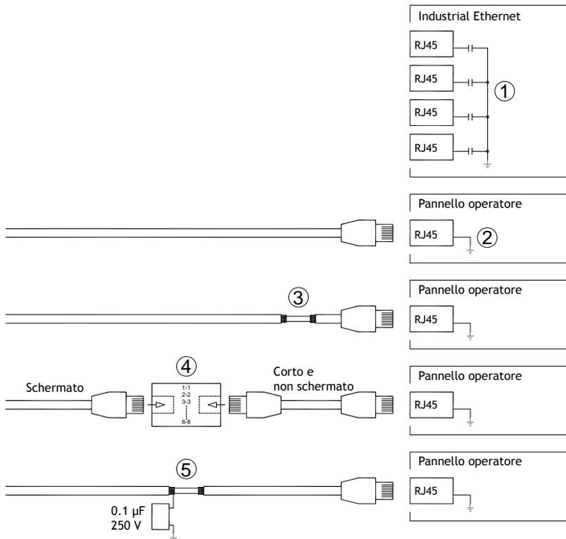
In alcune unità Ethernet industriali, la schermatura del connettore RJ45 è collegata al telaio mediante un condensatore, vedi 1 nel disegno sopra.
