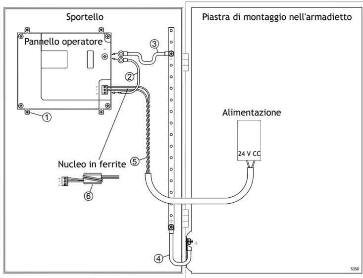
I morsetti di montaggio del pannello operatore non offrono un collegamento a terra sicuro tra pannello e armadio dei dispositivi, vedi 1 nel disegno sopra.
