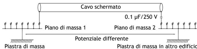
Con distanze maggiori, sussiste il rischio che il potenziale di terra possa essere diverso. In questo caso, lo schermo deve essere collegato solamente ad una estremità. Una buona alternativa è collegare l'altra estremità dello schermo a terra tramite un condensatore plastico da 0,1 µF/250 V. In questo modo, entrambe le estremità sono collegate a terra per quanto riguarda HF, ma solamente ad una estremità per quanto riguarda LF, evitando così i loop di terra a 50/60 Hz.
