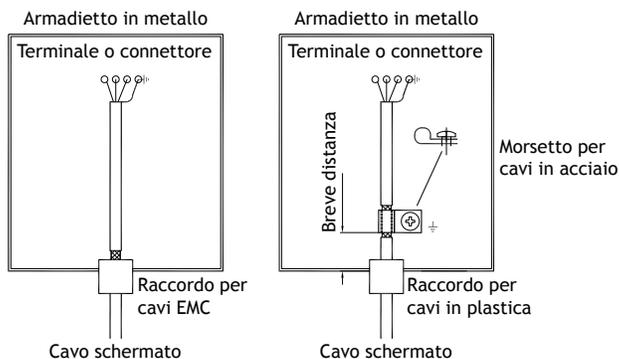
1. Utilizzare un raccordo per cavi EMC o regolare, rimuovere la guaina esterna e collegare lo schermo alla piastra d'installazione con un morsetto a 360° di metallo.
