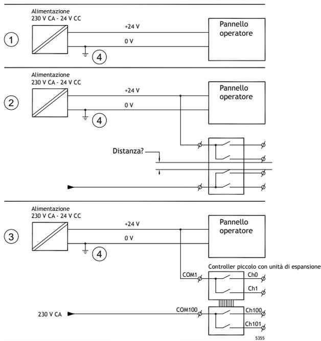
Se si utilizza un'alimentazione che soddisfa le norme di sicurezza e alimenta solamente il pannello operatore, non ci sono problemi. Vedere 1 nella figura sopra.
