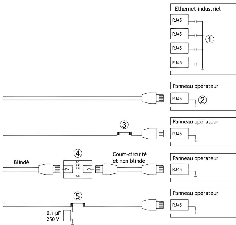
Dans certaines unités industrielles pour Ethernet, le blindage du contact RJ45 est raccordé au châssis via un condensateur, voyez 1 en dessinant en haut.
