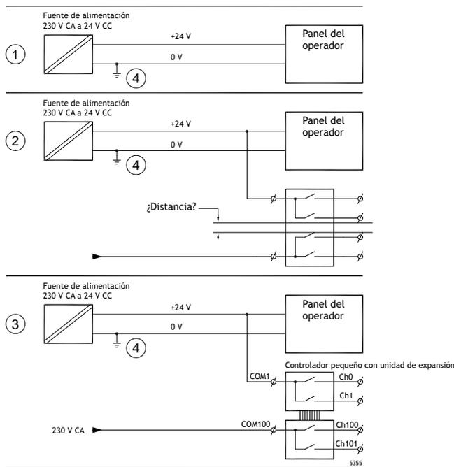
Si se utiliza una fuente de alimentación que cumpla con las normas de seguridad y sólo se utiliza para alimentar el panel de operador, no surgirá ningún problema. Véase el nº 1 en el esquema anterior.
