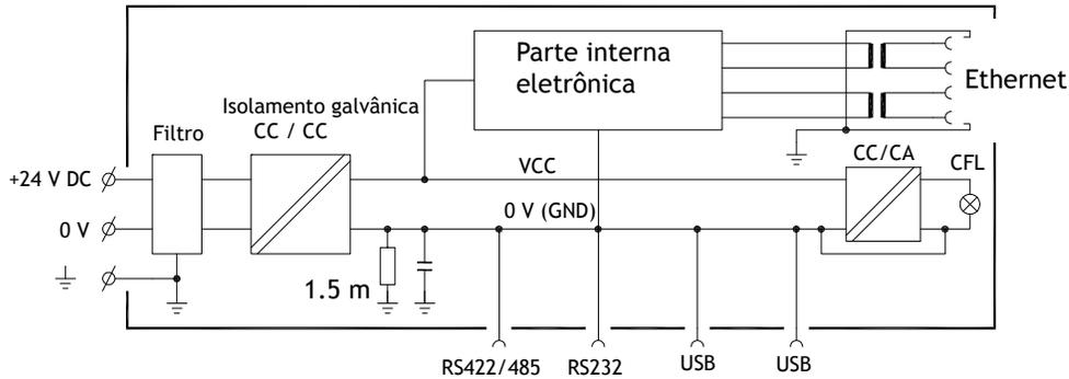
O painel do operador apresenta isolamento galvânico contra alimentação de 24V CC, mas não entre as portas de comunicação para RS232, RS422/485 e USB. Apenas a conexão Ethernet tem isolamento galvânico.
