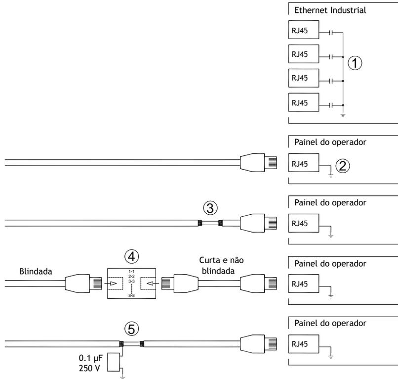
Em algumas unidades industriais de Ethernet, o contato blindado RJ45 conectada ao chassi através de um capacitor, conforme a ilustração 1 no desenho acima.
