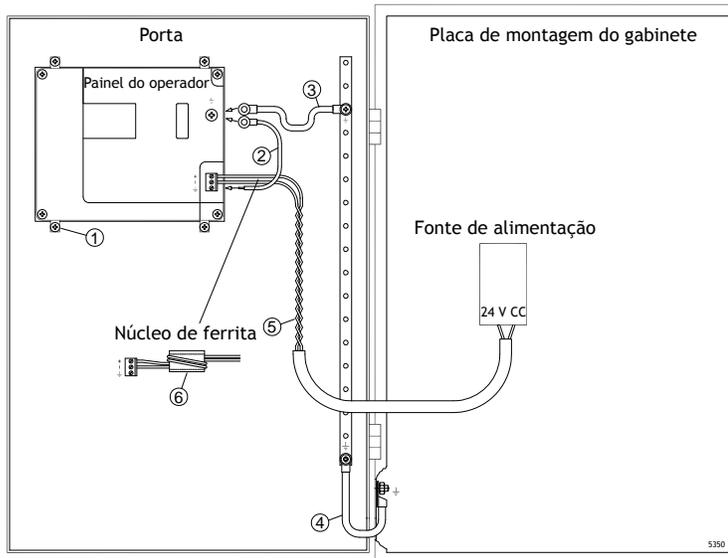
As braçadeiras de montagem do painel do operador não proporcionam uma conexão de aterramento segura entre o painel e o gabinete do dispositivo. Consulte a ilustração 1 no desenho acima.
