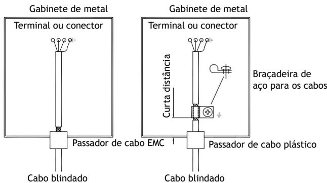
1. Use um passador de cabo EMC ou um de plástico regular. Remova a jaqueta externa e conecte a blindagem à placa de instalação com uma braçadeira de metal de 360°.
