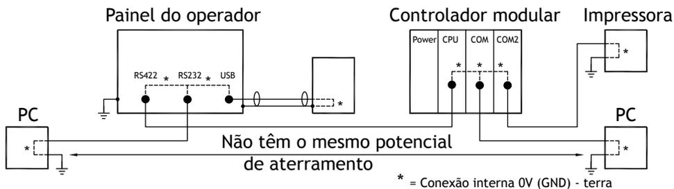
Quando o PC está conectado ao painel do operador, o a conexão interna de 0V (GND) do painel pode ser conectadas ao terra através de um PC.
