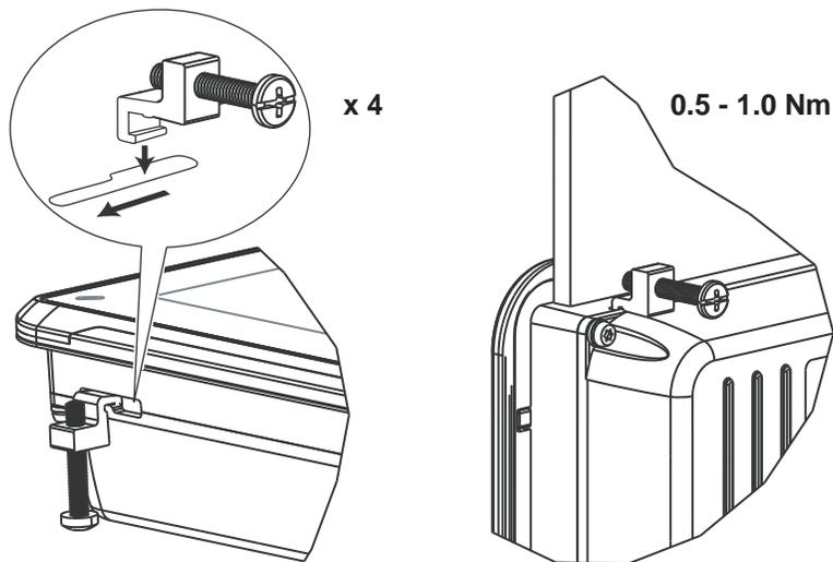
4. 根據下面的圖示與步驟，依序連接纜線。
