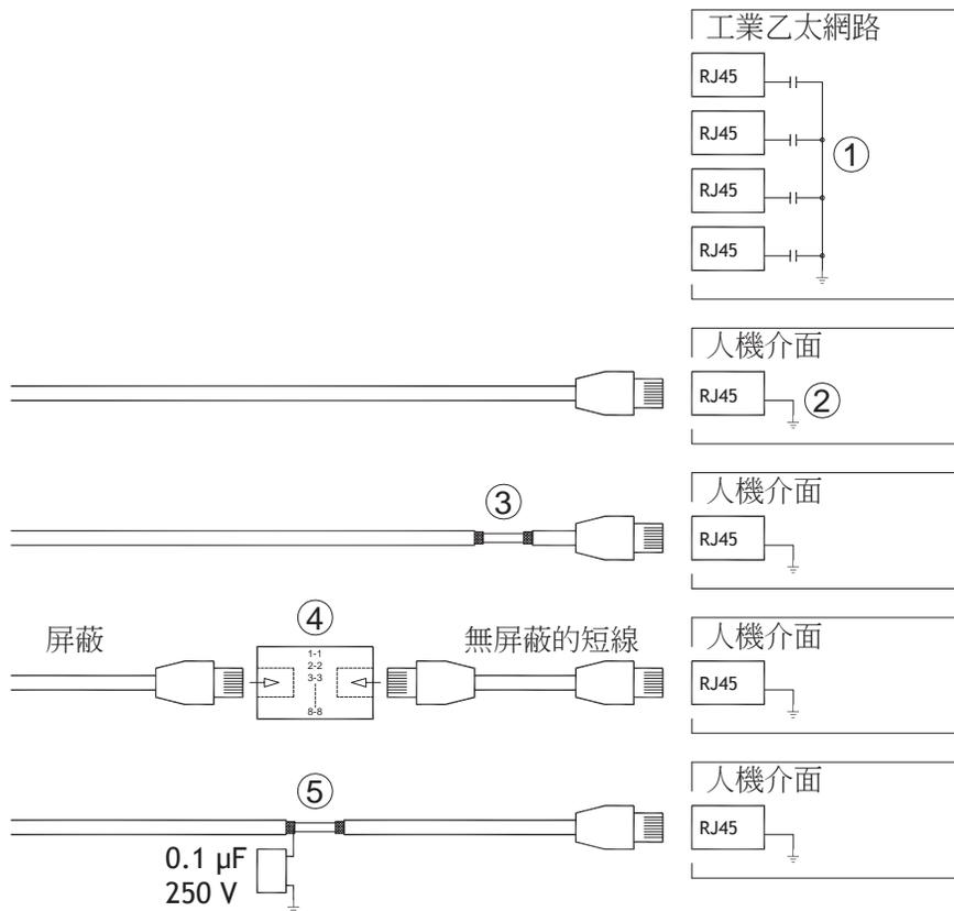
在部份乙太網路的工業裝置中，RJ45接頭的屏蔽是透過電容器與底座連接的，請參見上圖中的1部份。
