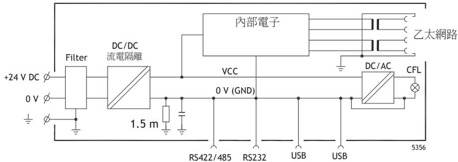
人機介面與 24V 直流電之間有電流隔離，但是在 RS232、RS422/485 和 USB 之間則沒有電流隔離。只有乙太網路連接有電流隔離。
