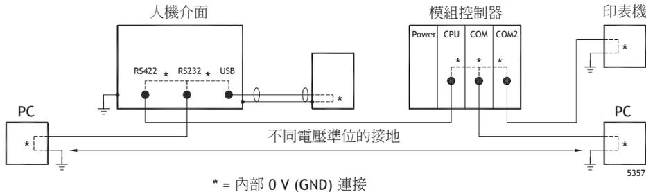
當將個人電腦與人機介面連接時，人機介面的內部 0V (GND) 將會透過個人電腦連接至保護接地。有一些 USB 裝置能夠將屏蔽與保護接地連接在一起。例如，在此處插入 USB 儲存裝置、鍵盤或類似裝置時，人機介面的 0V (GND) 會連接至保護接地。
