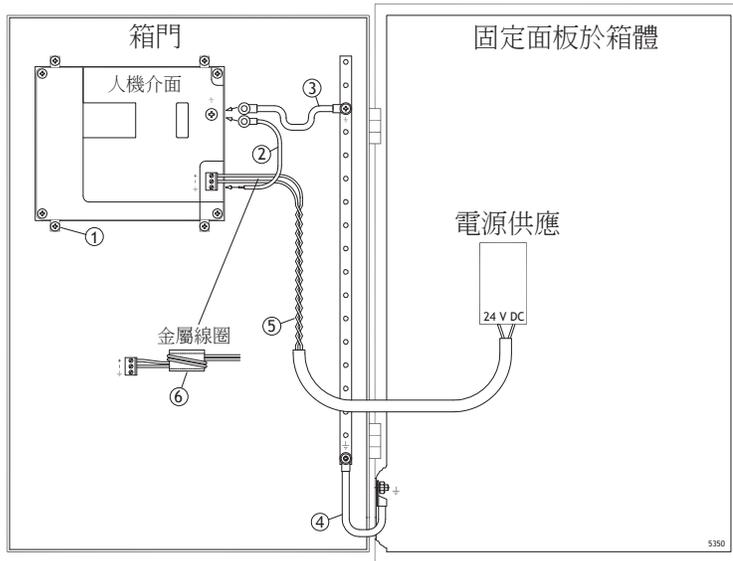
人機介面的安裝螺絲並未在面板與裝置機箱間提供牢固的接地連接，請參見上圖中的1部份。
