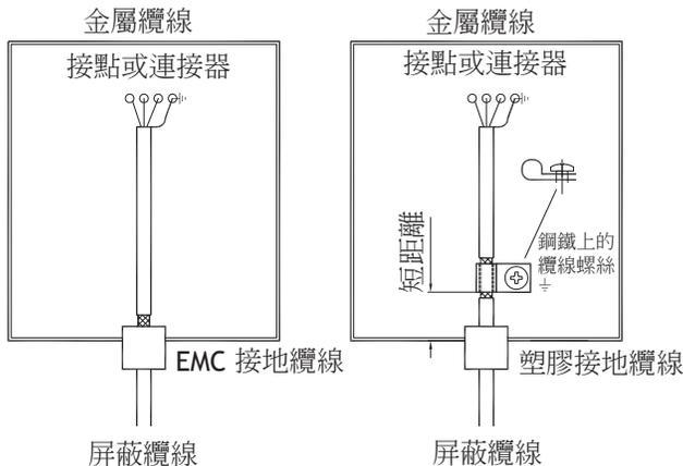
1. 使用EMC纜線固定頭或正規的塑膠纜線固定頭，將外部的保護罩取下，然後使用360°的金屬纜線夾頭將屏蔽連接至安裝板。
