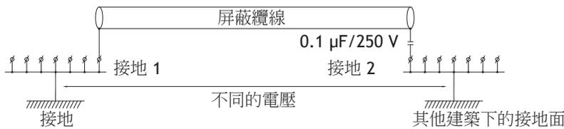
當距離變長時，可能會產生接地出現變化的風險。若發生此情況，建議只連接屏蔽的一端。另一個替代方式是將屏蔽的另一端透過0.1 μF/250 V塑膠電容器連接至地面。若為高頻環境，請將兩端都連接至地面。若為低頻環境，請將一端連接至地面，即可避免50/60Hz接地迴路。
