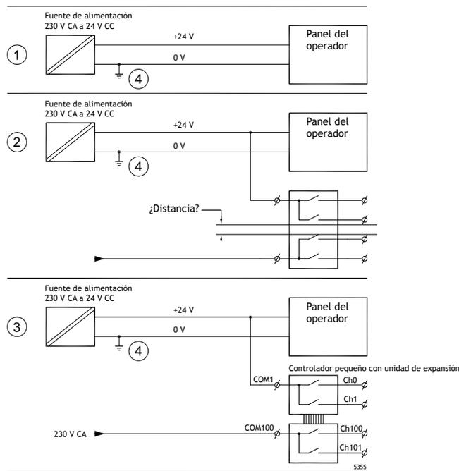
Si se utiliza una fuente de alimentación que cumpla con las normas de seguridad y sólo se utiliza para alimentar el panel de operador, no surgirá ningún problema. Véase el n° 1 en el esquema anterior.
