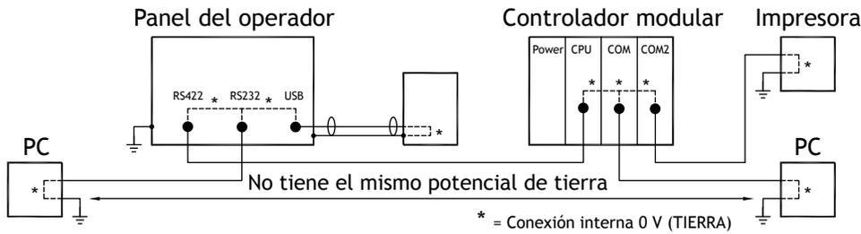
Cuando un ordenador se encuentre conectado al panel del operador, la conexión interna del panel de 0 V (GND) se conectará a la toma de tierra protectora a través de dicho ordenador.
