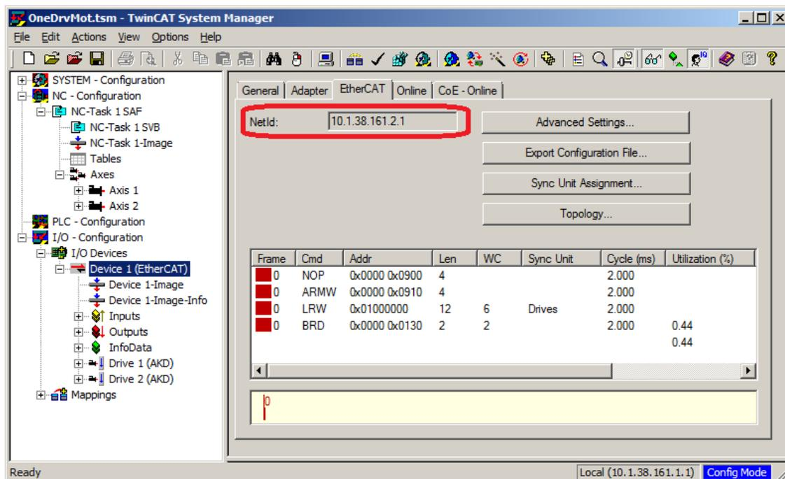
Il est important de bien comprendre que ces informations proviennent du fichier de configuration du maître TwinCAT et non du variateur même. Par conséquent, si la configuration de TwinCAT ne reflète pas la configuration réelle du réseau, il est possible qu'un variateur répertorié dans WorkBench ne soit pas sous tension, voire même connecté au réseau EtherCAT, ou qu'un variateur soit sous tension et connecté au réseau EtherCAT sans apparaître dans la liste de WorkBench.
