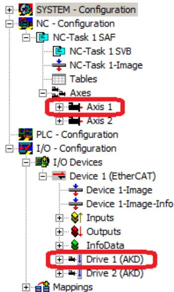
Pour pouvoir assurer la connexion aux variateurs en utilisant WorkBench, les variateurs doivent être en état Pre-Op, Safe-Op ou Op. La machine d'état associée à un variateur est accessible dans l'onglet En ligne, sous le nœud Configuration E/S → Périphériques E/S → Périphérique [x] → Variateur [x]. Voir la capture d'écran ci-après.
