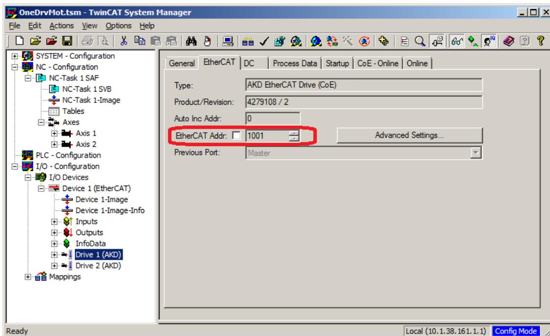
L'identifiant réseau est spécifié dans l'onglet EtherCAT, sous le nœud I/O Configuration → I/O Devices → Device [x].
